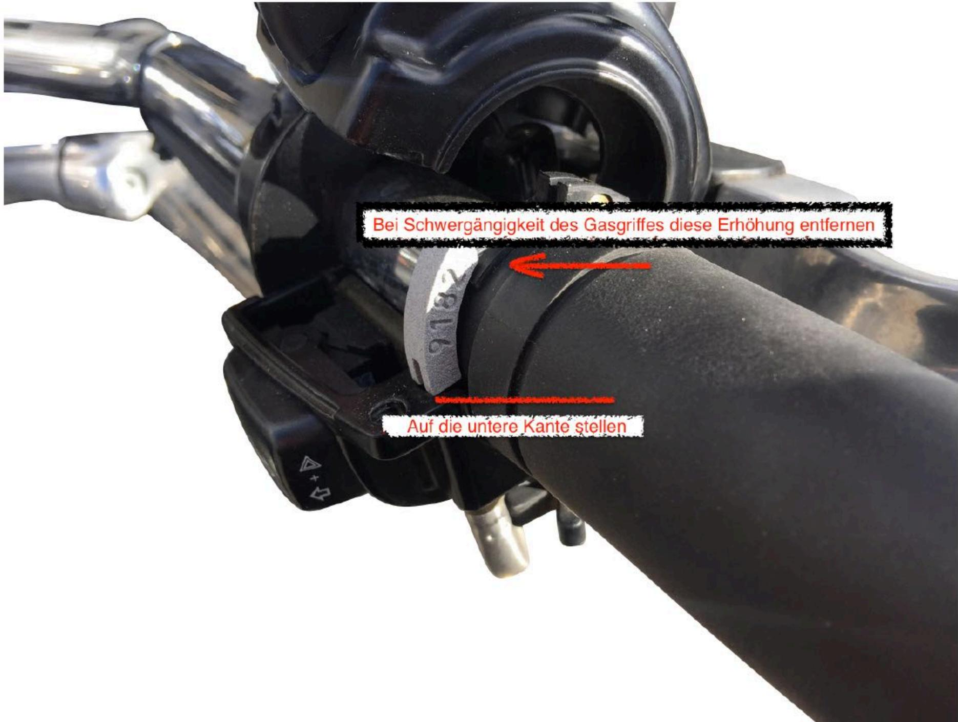
Bei Schwergängigkeit des Gasgriffes diese Erhöhung entfernen
