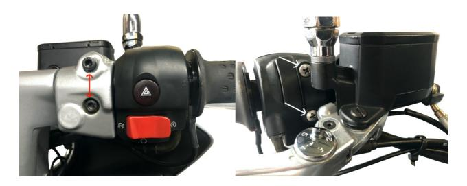
Trennen Sie die Gehäusehälften und legen den 3P Limiter wie auf dem Bild zu sehen in die untere Schale ein.
