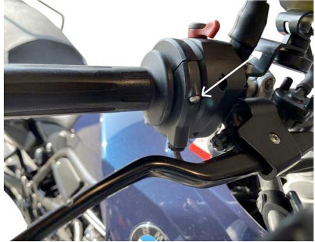
Schieben Sie den Limiter in die Vertiefung des Drehgriffes
