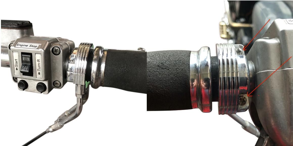
Legen Sie den 3P Limiter wie auf der Abbildung zu sehen in das Gasgriff Gehäuse.
