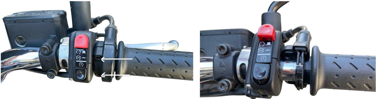
Trennen Sie die Gehäusehälften und legen den 3P Limiter wie auf dem Bild zu sehen auf dem Gasdrehgriff.
