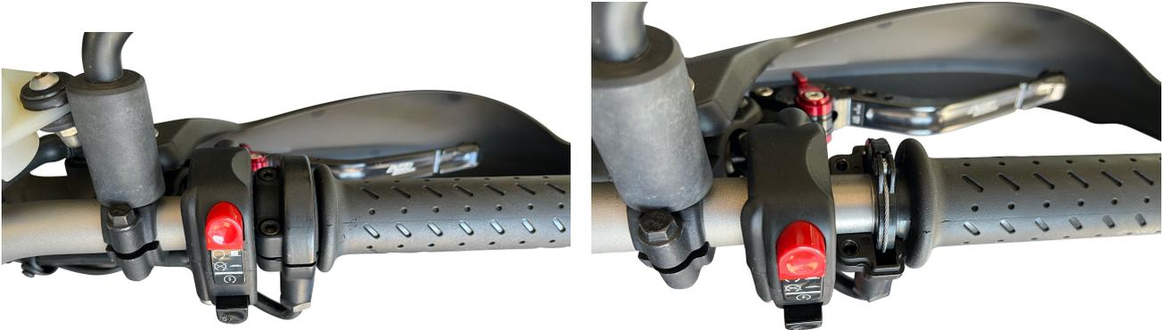
Trennen Sie die Gehäusehälften und legen den 3P Limiter wie auf dem Bild zu sehen auf dem Gasdrehgriff.
