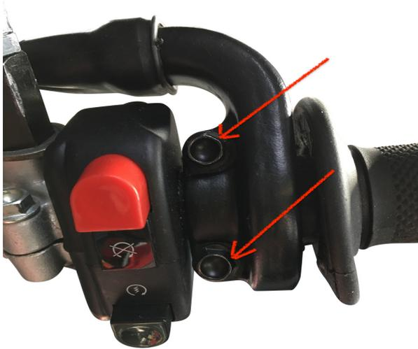
Legen Sie den 3P Limiter wie auf der Abbildung zu sehen in den unteren Bereich der hinteren Gasgriffschale
