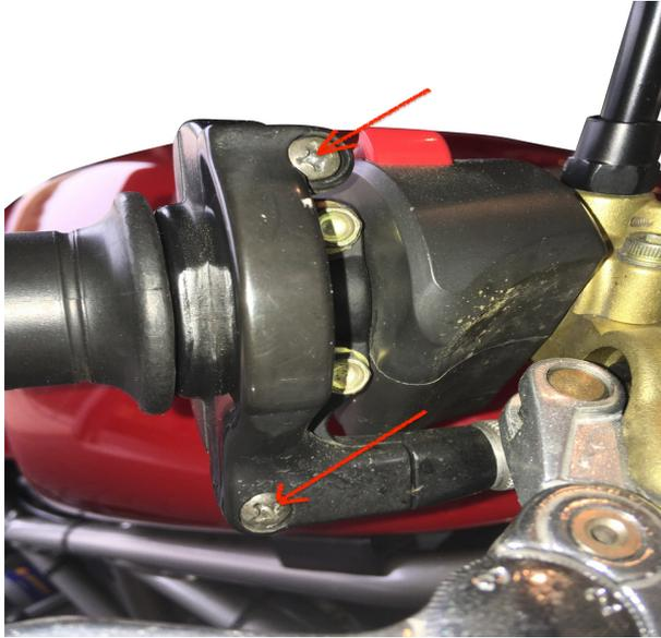
Legen Sie den 3P Limiter wie auf der Abbildung zu sehen über den Gasdrehgriff
