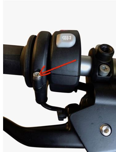
Legen Sie den 3P Limiter wie auf der Abbildung zu sehen in das Gasgriff Gehäuse.
