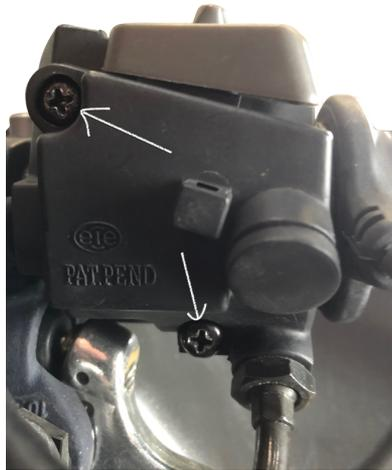
Legen Sie den 3P Limiter wie auf der Abbildung zu sehen auf das Gassgriff Gehäuse, mit der Spitze in die unterste Ecke
