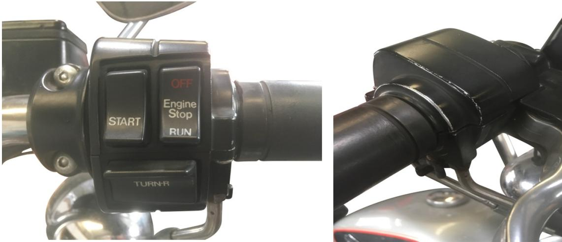
Legen Sie den 3P Limiter wie auf der Abbildung zu sehen auf das Gassgriff Gehäuse, mit der Spitze in die unterste Kante
