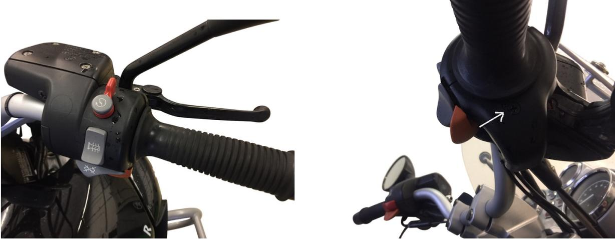
Legen Sie den 3P Limiter wie auf der Abbildung zu sehen auf das Gassgriff Gehäuse, mit der Spitze in die unterste Ecke
