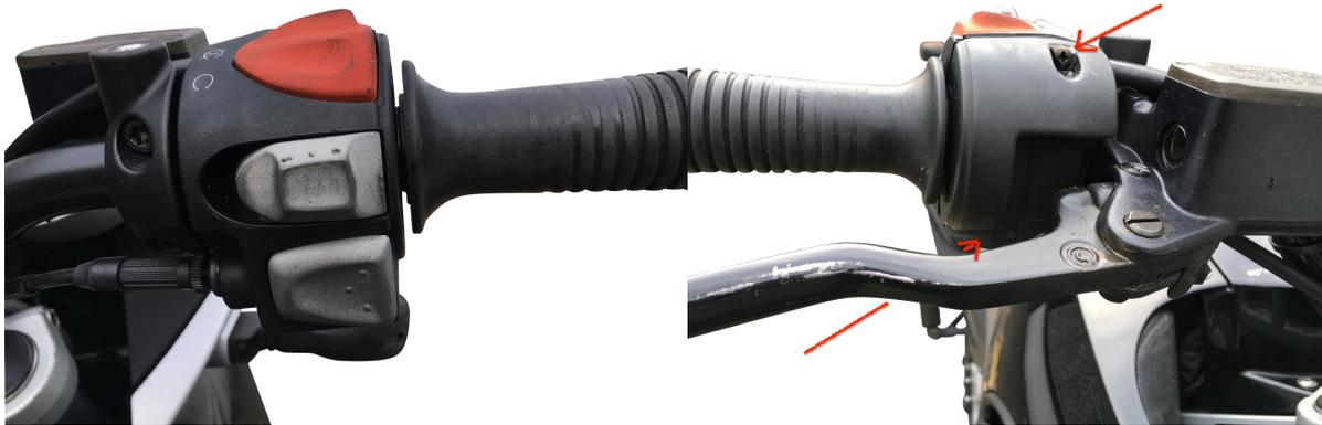
Entfernen Sie die Gasgriffschnecke und legen den 3P Limiter mit etwas Fett in das Gasgriffgehäuse.
