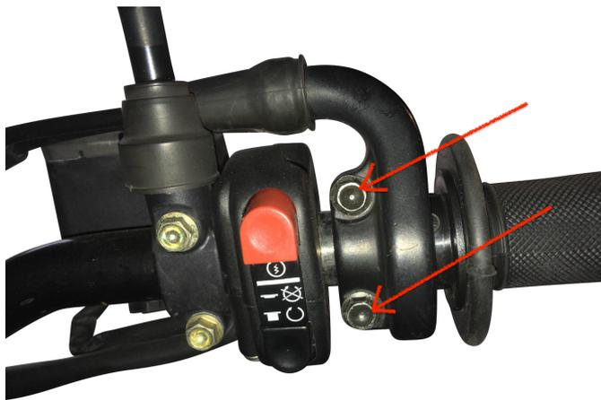
Legen Sie den 3P Limiter wie auf der Abbildung zu sehen über den Gasdrehgriff
