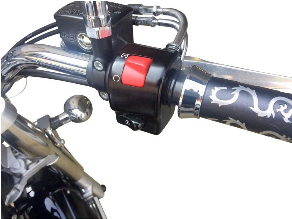
Entfernen Sie die beiden Kreuzschlitzschrauben
