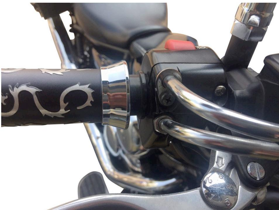
Legen Sie den 3P Limiter wie auf der Abbildung zu sehen in die vordere Gasgriffschale
