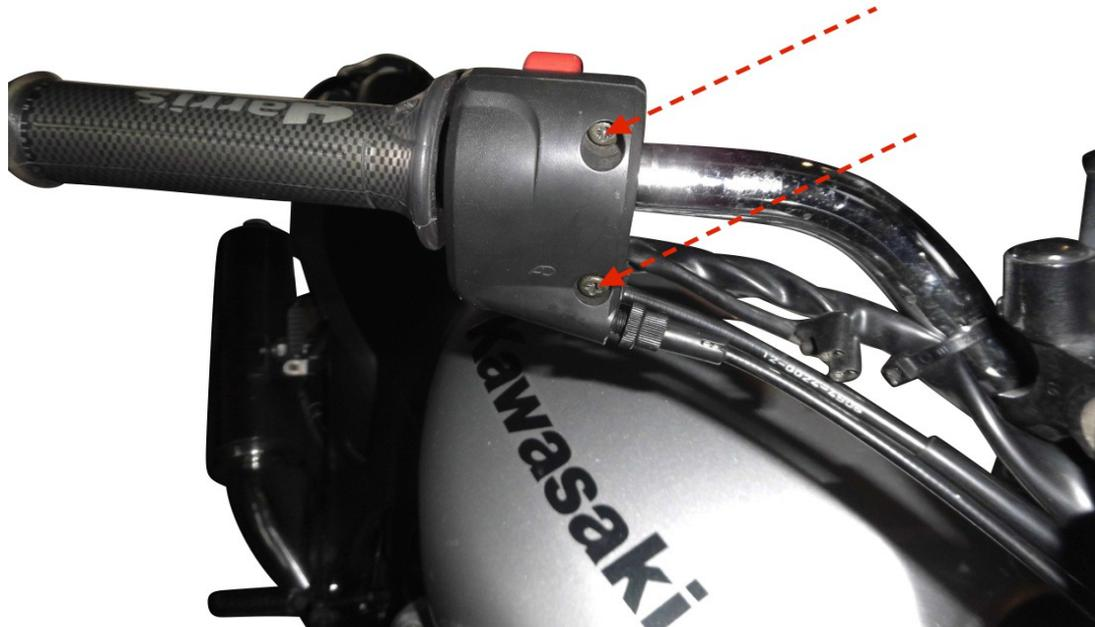
Legen Sie den 3P Limiter wie auf der Abbildung zu sehen in die vordere Gasgriffschale
