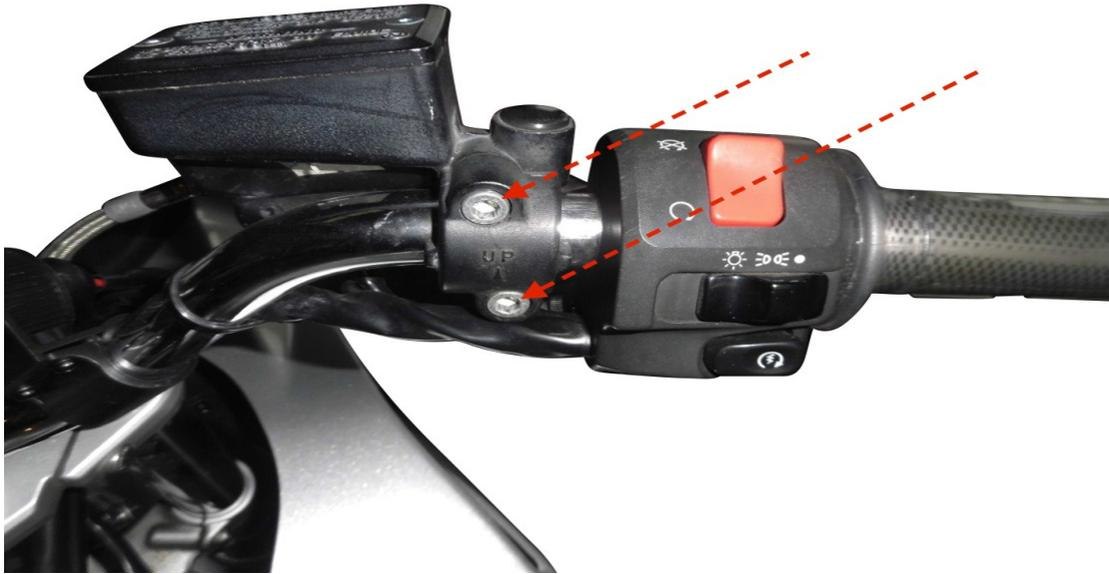
Legen Sie den Handbremspumpe waagrecht zur Seite, so dass keine Bremsflüssigkeit auslaufen kann.
