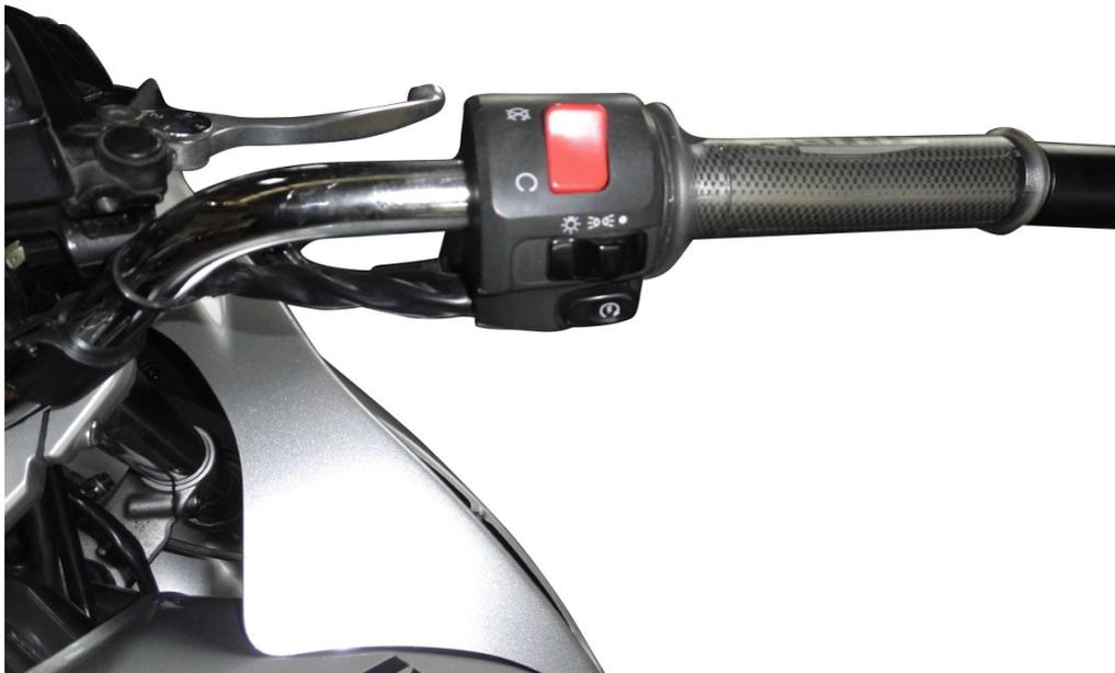
Demontieren Sie beiden hinteren Schrauben der Gasgriffschale und ziehen die vordere Gasgriffschale in Richtung Sitzbank.
