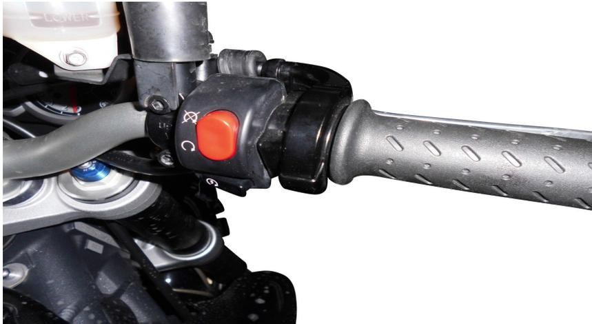
Legen Sie den Limiter wie auf der Abbildung zu sehen auf die unter Schale des Drehgasgriffes
