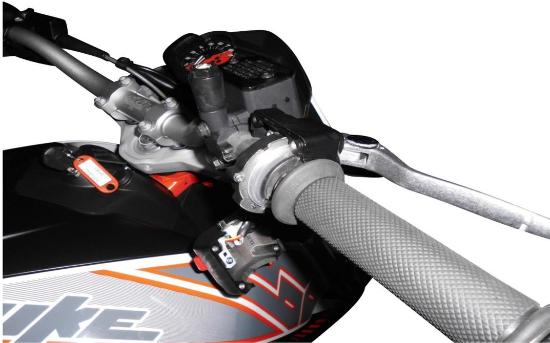
■ Lösen Sie die Inbusschraube des Lenkergewichtes und ziehen Sie das Gewicht vom Lenker .
