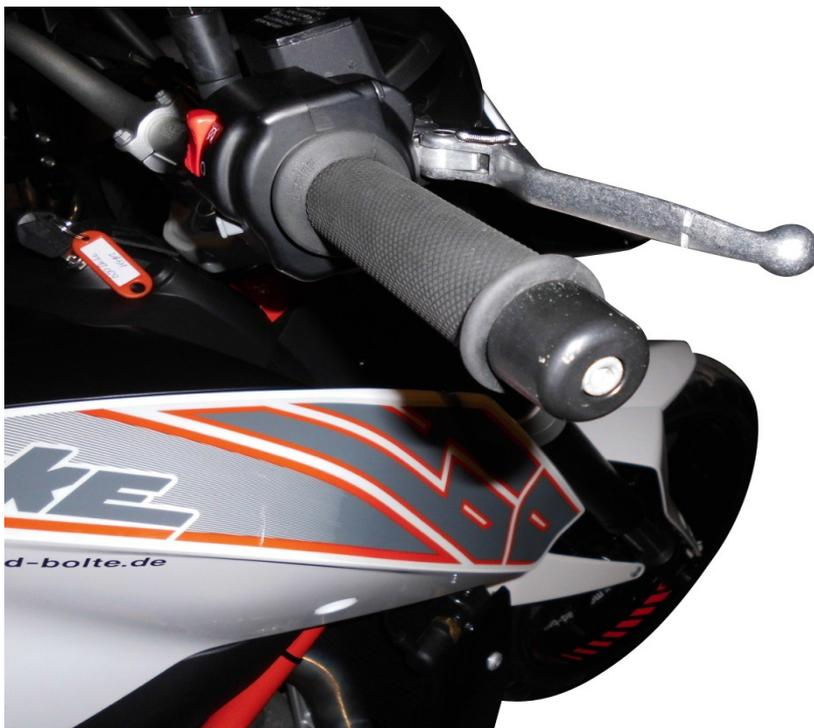
Legen Sie den 3P Limiter wie auf der Abbildung zu sehen auf den oberen Rand des Drehgasgriffes und montieren Sie in umgekehrter Reihenfolge alles zusammen.
