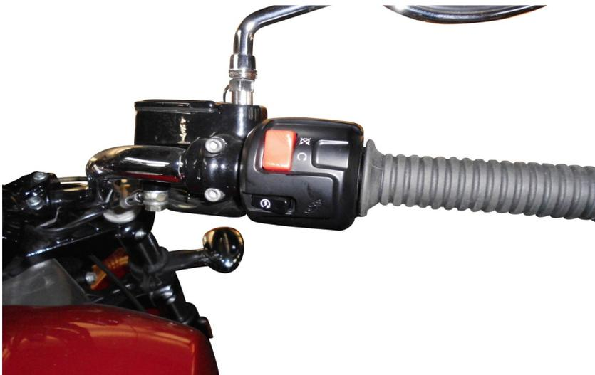
Entfernen Sie die 4 Schrauben der hinteren Verschalung und ziehen den Drehgasgriff vom Lenker.
