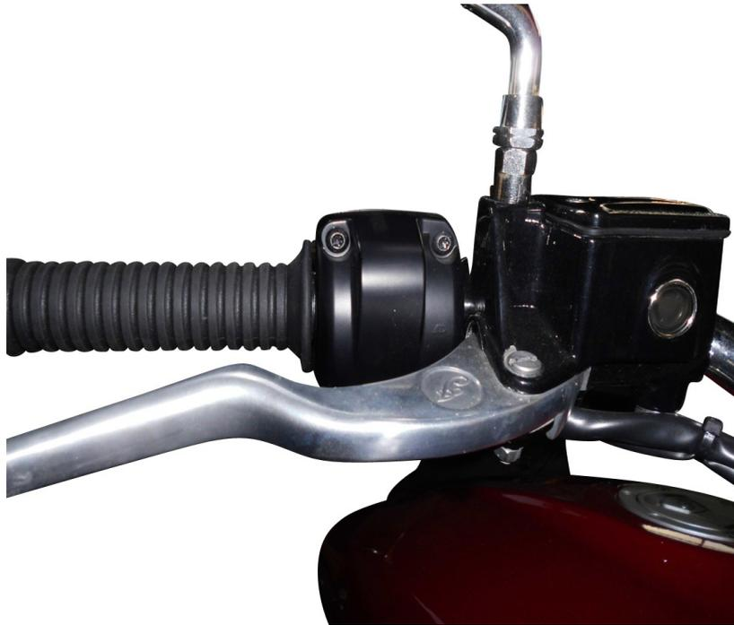
Kleben Sie unter Hinzunahme von Sekundenkleber den 3P Limiter auf den Drehgasgriff
