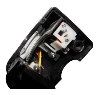
Montieren Sie die obere Schale durch festziehen der beiden Kreuzschlitzschrauben der unteren Schale.
