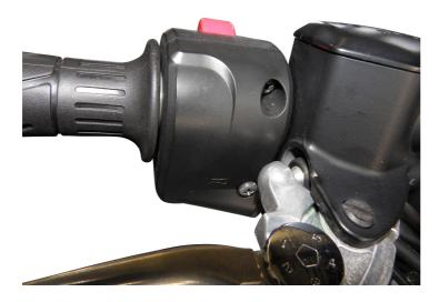
Entfernen Sir die Ober und Unterschale vom Gasdrehgriff und legen den 3P Limiter , in die untere Schale, wie in der Abbildung zu sehen.
