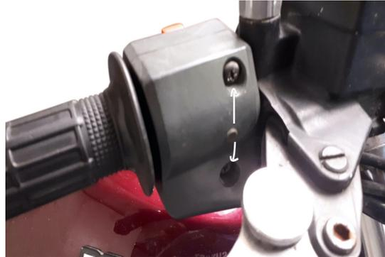
Legen Sie den 3P Limiter wie auf der Abbildung zu sehen in das Gasgriff Gehäuse.
