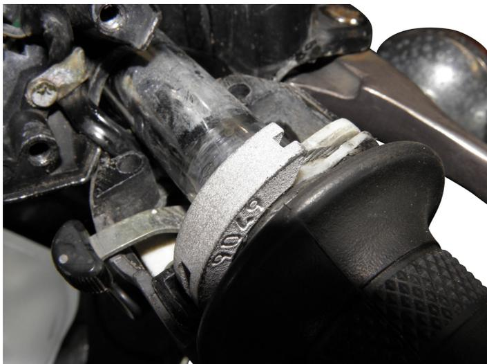
Montieren Sie die obere Schale durch festziehen der beiden Schlitzschrauben der unteren Schale.
