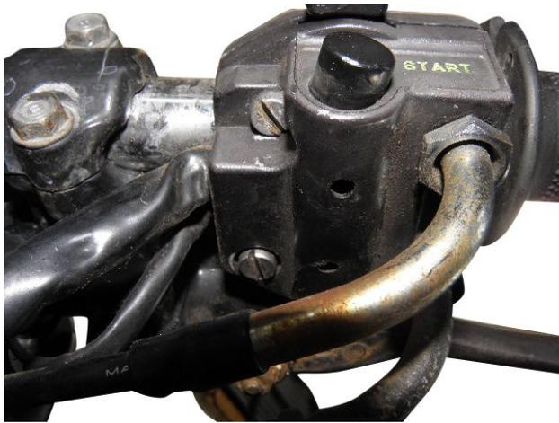
Entfernen Sie die Ober- und Unterschale vom Gasdrehgriff und legen den 3P Limiter, in die untere Schale, wie in der Abbildung zu sehen.
