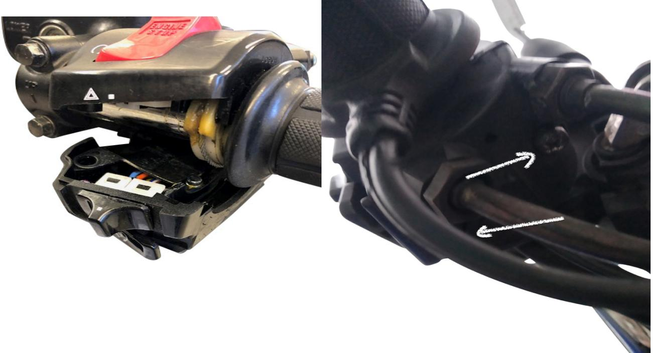
Legen Sie den Limiter wie auf der Abbildung zu sehen in der unter Schale des Drehgasgriffes
