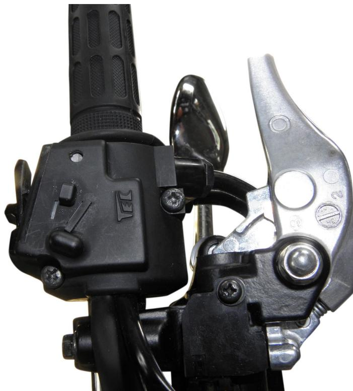
Entfernen Sie die Ober- und Unterschale vom Gasdrehgriff und legen den 3P Limiter, in die untere Schale, wie in der Abbildung zu sehen. Das dicke Ende in die Vertiefung legen und das verlängerte Ende muss in der Schale hoch stehen.
