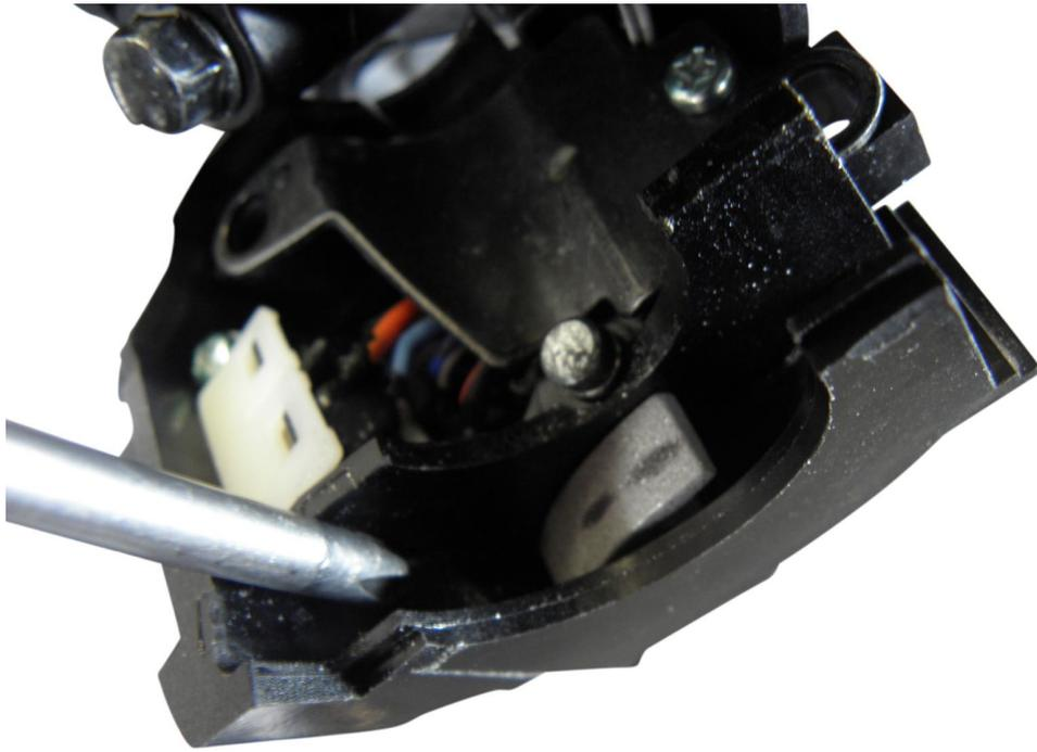
Montieren Sie die obere Schale durch festziehen der beiden Kreuzschlitzschrauben der unteren Schale.
