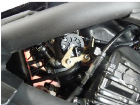
1 ) Unterhalb der Drehscheibe der Ansaugbrücke demontieren Sie die beiden M5 Schrauben.
