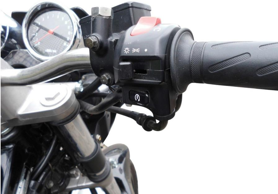
Legen Sie den Limiter wie auf der Abbildung zu sehen in die untere Schale des Drehgasgriffes
