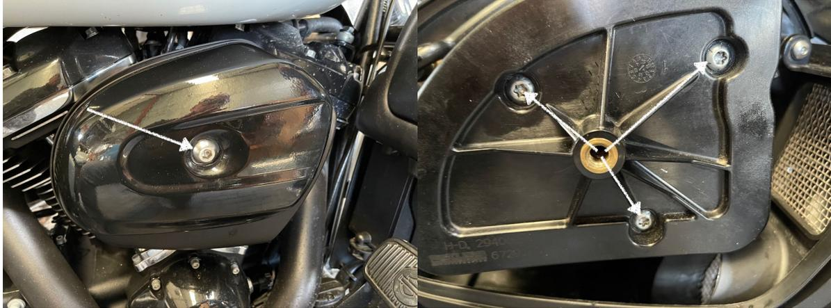
Durch abziehen des Schlauches gelangen Sie an die beiden Schrauben die das Gehäuse des Luftfilters mit dem Einspritzgehäuse verbindet.
