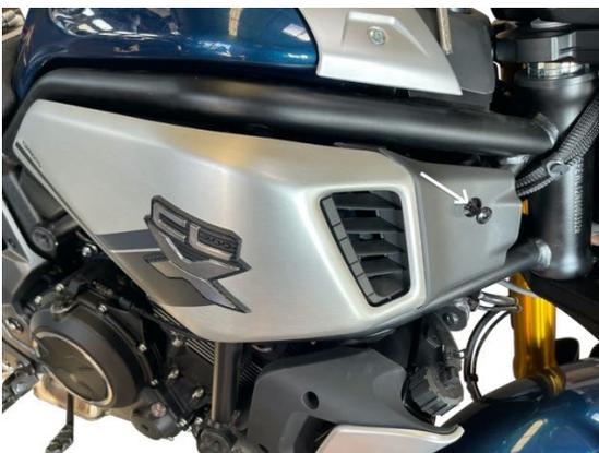
Demontieren Sie die drei Schrauben der ECU Halterung und klappen dieses nach unten und entfernen die darunterliegende Abdeckung.
