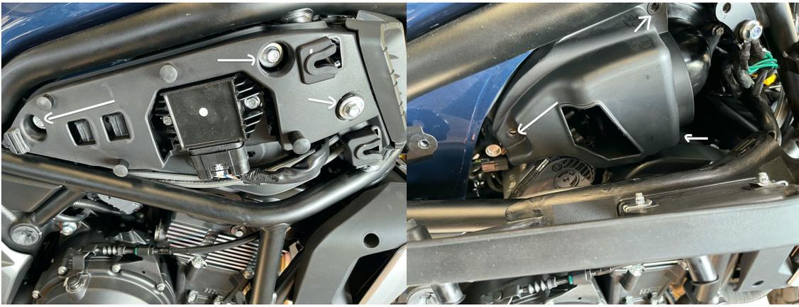
**Demontieren Sie den Luftfiltereingang und montieren die Luftfilterverengung.**
