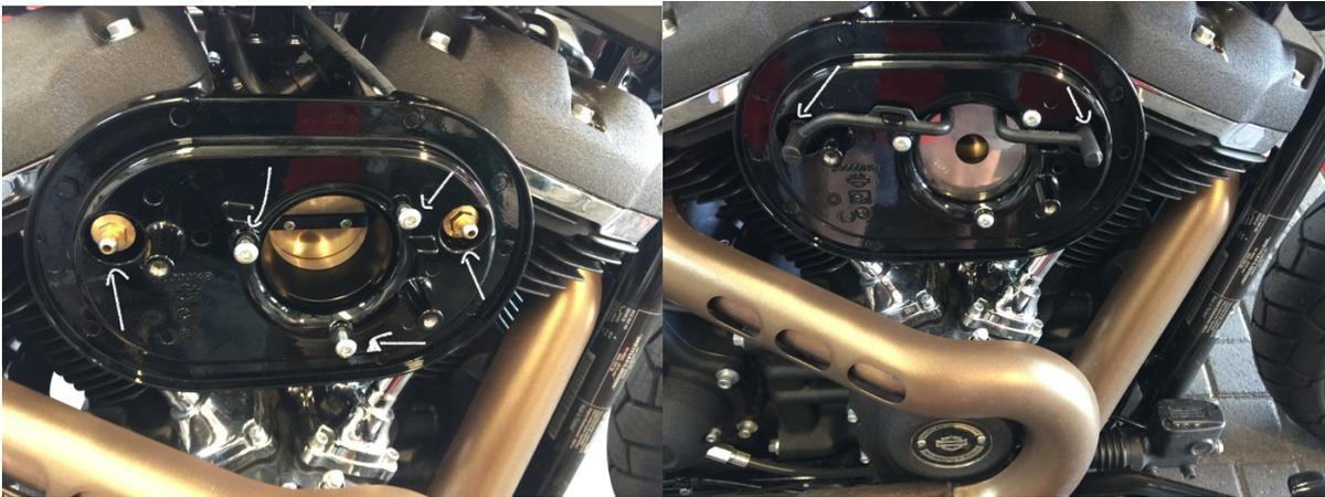
Trennen Sie den Stecker vom Stellmotor und verbinden Sie den 3P Connector mit den Kabelenden.
