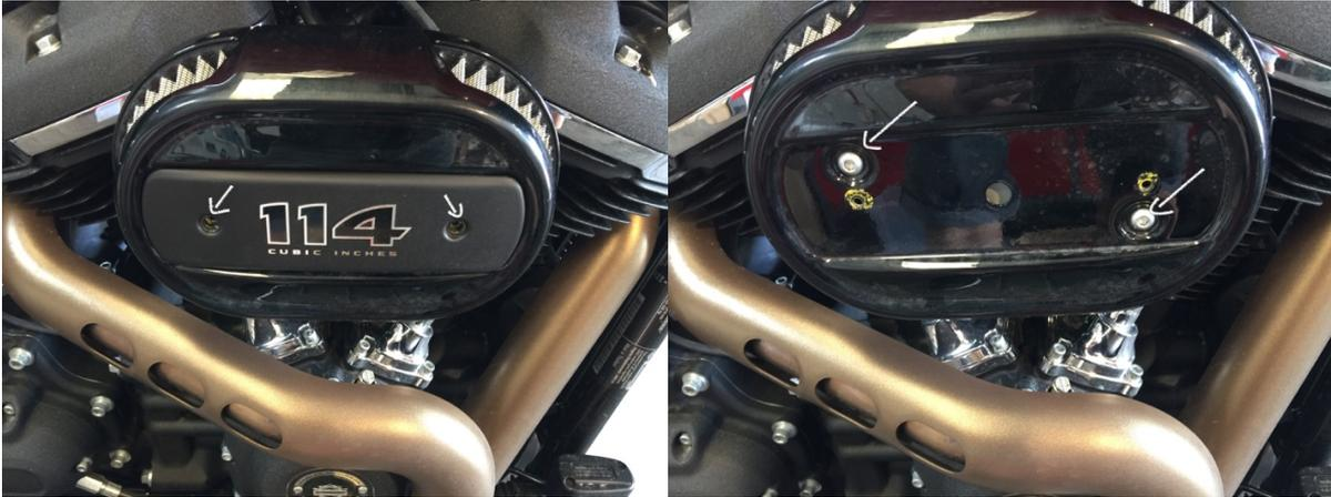
Nach Demontage des Luftfilters montieren Sie die Blende
