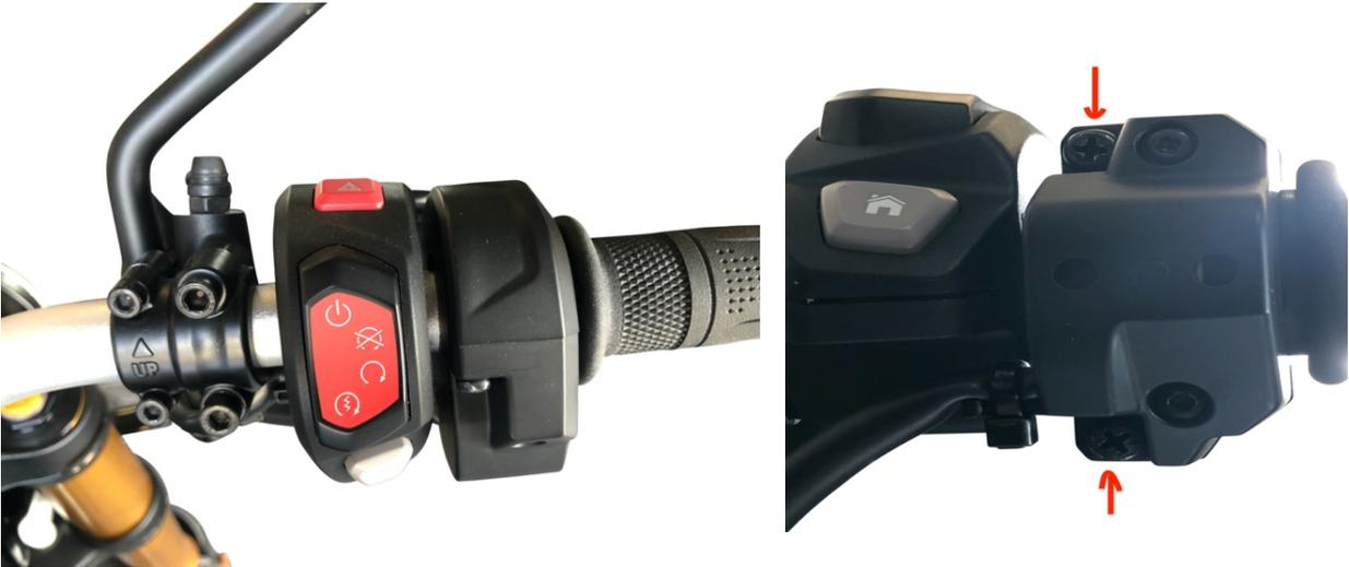
Legen Sie den 3P Drehwinkelbegrenzer wie auf der Abbildung zu sehen in dem Zwischenraum des Drehgriffes
