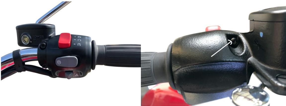
**Legen Sie den 3P Drehwinkelbegrenzer wie auf der Abbildung zu sehen in dem Zwischenraum des Drehgriffes**
