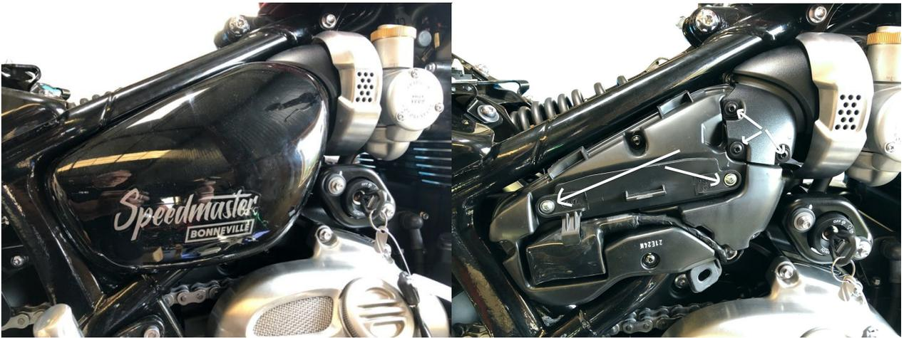
**Drücken Sie die beiden Luftfilterverengungen in die Vertiefung**
