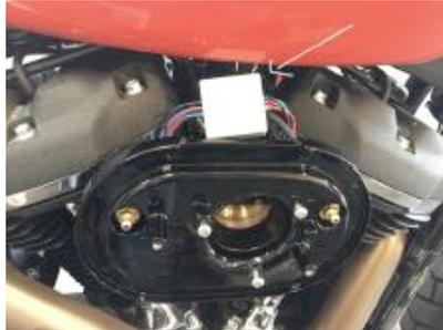
Legen Sie den 3P Connector sichtbar über den Luftfilterkasten und stellen Sie sicher das der Connetor nicht an heiße Motorteile anliegt.
