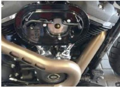
Nach Demontage des Luftfilters montieren Sie die Blende
