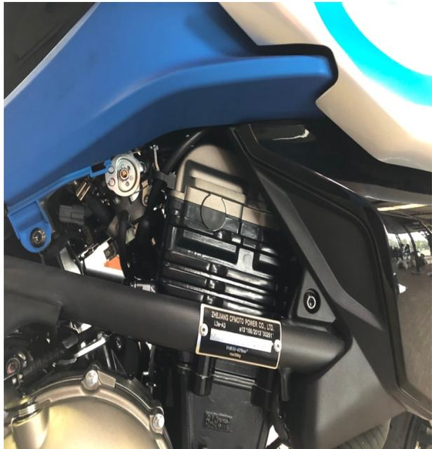
Nach der Demontage der Seitenverkleidungen können nun die zwei hinteren Schrauben der Blende am Steuerkopf entfernt werden.
