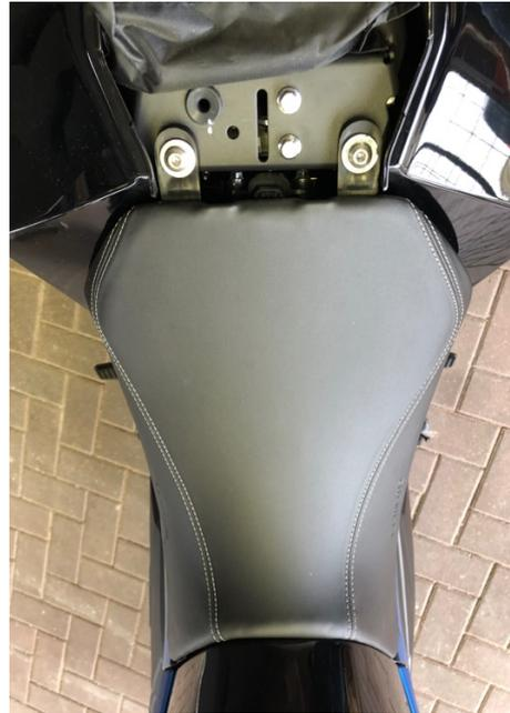
Jetzt die Rahmenverkleidungen re. und li. durch Lösen jeweils einer Schraube demontieren. Neben den Schrauben werden die Blenden durch zwei Zapfen am Rahmen fixiert.
