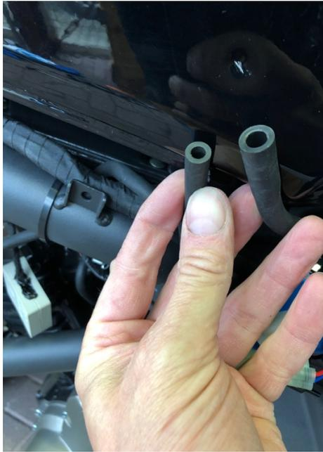
Nun die Schrauben des Luftfilterdeckels entfernen, dann den Deckel leicht anheben und die mitgelieferten Reduzierhülsen in die zwei Ansauggummi einsetzen.
