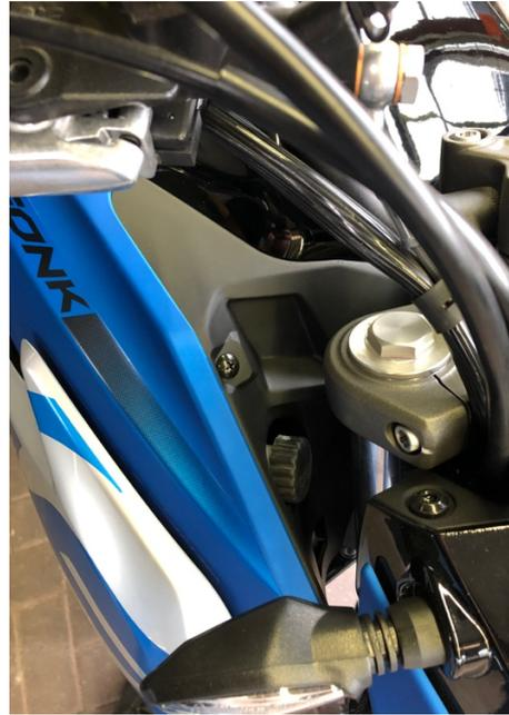
Als nächstes die vier Schrauben die die Seitenverkleidungen halten Entfernen und die Verkleidungen aus den Haltegummis ziehen.
