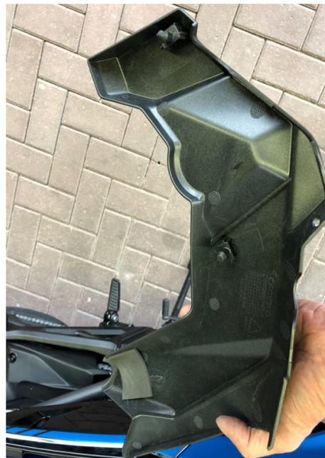
Nun die vordere Blende am Steuerkopf durch das Entfernen der Befestigungsschrauben lösen.
