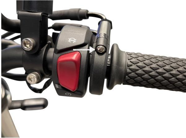
Trennen Sie die Gehäusehälften und legen den 3P Limiter wie auf dem Bild zu sehen in die Gehäusehälfte auf die vorstehende Kante
