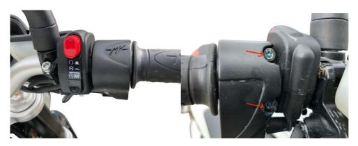
Entfernen Sie die Gehäusehälfte und demontieren das Lenkergewicht
