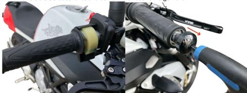
Schieben Sie dem Griff bis zum Lenkerende und hebeln den Griff vom Lenker um den Limiter einzulegen
