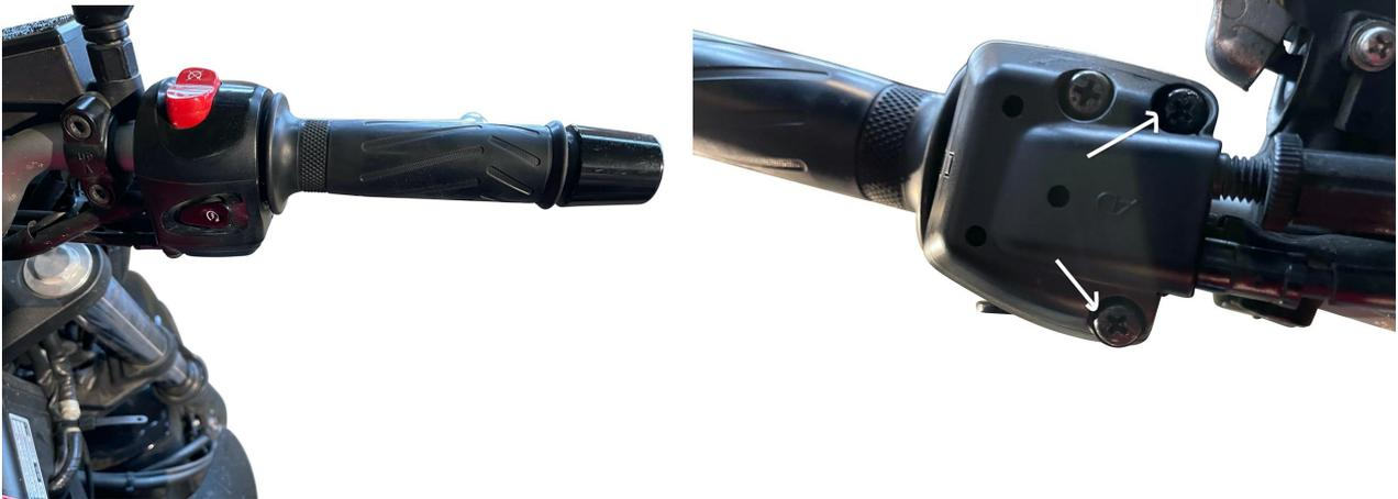
Legen Sie den 3P Limiter wie auf der Abbildung zu sehen in das Gasgriff Gehäuse.
