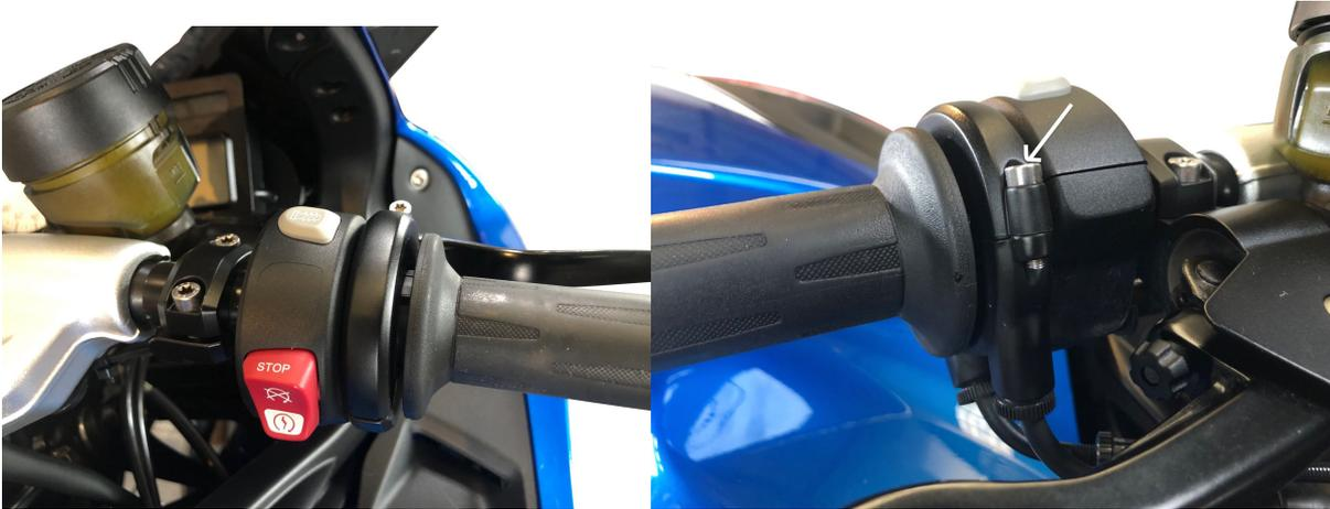
Legen Sie den 3P Limiter wie auf der Abbildung zu sehen in das Gasgriff Gehäuse.
